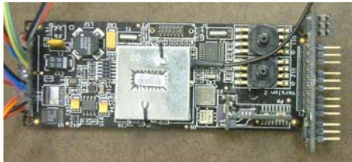
**Figure 9. Micropilot g2028 Autopilot System**
