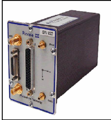
**Figure 4 - Piccolo Avionics Unit**
