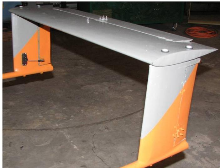
**Figure 8 Empennage of X<sup>2.5</sup>**
