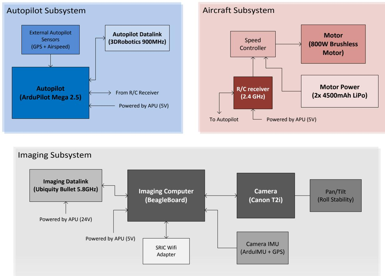
**Figure 1: UAS Subsystem Block Diagram**
