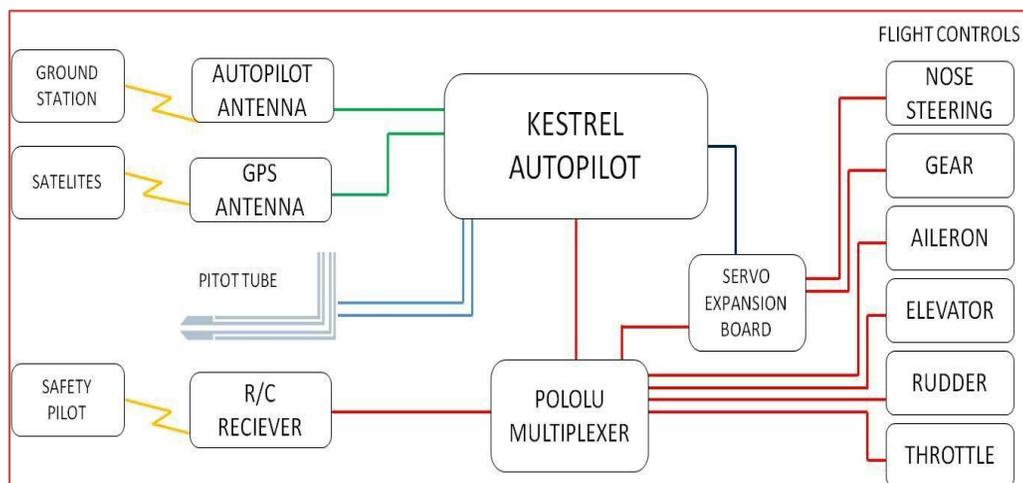
FIGURE 2 FLIGHT CONTROL SYSTEM DESIGN
