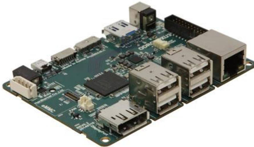
FIGURE 6: ONBOARD COMPUTER (ODROID XU3)
